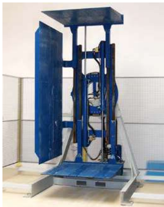
1,6T451W/099 - Инвертер для высвобождения поддона
