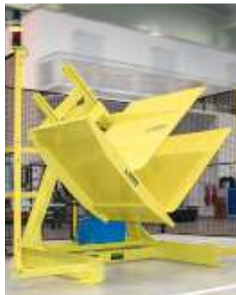
1,6T451W/099 - Инвертер для высвобождения поддона
